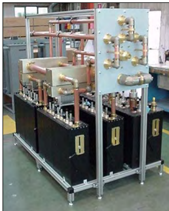
Patch panel with diplexer embendedd for BIII Cuadro conmutador con multiplexor embedido
